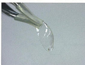
図13 プラズマコーティング前後のレンズ表面の濡れの変化
